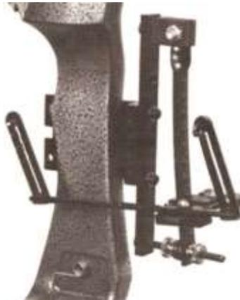
Exemple "peep elimination", il n'y a pas de visette dans la corde, mais il y a un viseur et un euilleton sur le viseur.
